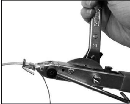
2. Eine Schelle formen, indem man das Band durch die Schlaufe führt und darunter verbiegt. Das Schellenende in den Werkzeugkopf einlegen und in den Schlitz des Gewindedorns schieben. Die Verschlussklinke herunterdrücken und die Schelle durch Vorwärtsbewegungen des Ratschenhebels spannen.
