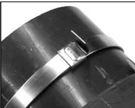
7. Das Ende der vorgefertigten Schelle in das Werkzeug einführen. Wie unter 2. und 3. spannen. Bei genügender Spannung den Verschluss ausklinken und das Werkzeug über den Gegenstand rollen. Abschneiden, ein Bandende wie oben gezeigt, zurücklassen.
