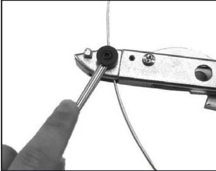
1. Mit geöffnetem Schlitz im Werkzeugkopf und mit dem Schneidhebel im rechten Winkel zum Werkzeug ein genügend langes Stück Band von einer 6 mm oder 10 mm breiten Rolle abschneiden. Das Band durch den Schlitz führen und abschneiden.
