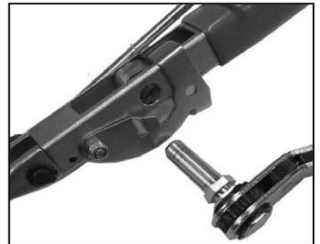
6. Das um den Gewindedorn verwickelte Band durch Anheben der Verschlussklinke entfernen. Ratschenschlüssel rückwärts drehen und Spannschlüssel vom Werkzeug entfernen.
