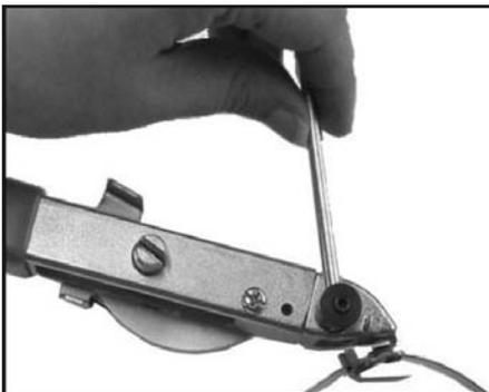
4. Bandende durch Anheben des Schneidhebels abschneiden.
