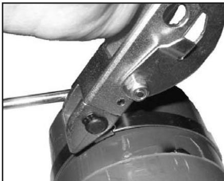
8. Dieses Bandende muss verkürzt werden. Das Werkzeug wird mit geöffneter Schneidvorrichtung über das Bandende gelegt. Das Bandende wird in den Schlitz geschoben und die überflüssige Länge abgeschnitten.
