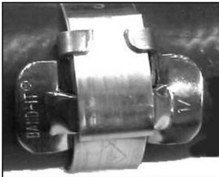
5. Schelle durch Verhämmern der Schlaufenösen fertigstellen. Hierzu kann das Stielende des Ratschenschlüssels benutzt werden.
