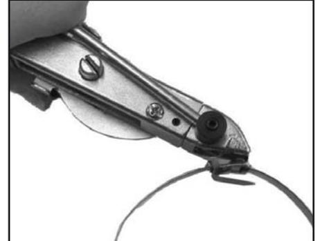
3. Bei genügender Spannung den Verschluss ausklinken und das Werkzeug über der Gegenstand rollen. Bitte beachten: Für extra Haltestärke wird doppelte Schlaufung des Bandes empfohlen.
